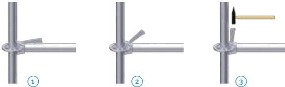
Die Anschlussscheibe hat vier kleine Löcher, welche um  $90^\circ$  versetzt angeordnet sind. Hier werden die Rohrriegel eingebaut, wenn exakt ein rechter Winkel im Grundriss erreicht werden soll. Dieser stellt sich dann beim Verkeilen weitestgehend automatisch ein.
