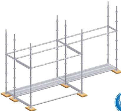
5. Vertikalstiele 3,00 m werden auf die Vertikal-Anfangsstücke aufgesteckt und in 2 m Höhe in Längsrichtung mit Rohrriegeln bzw. in Querrichtung mit U-Riegeln miteinander verbunden.
