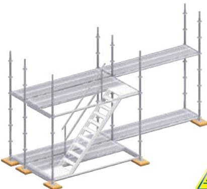
6. Dann werden die Alu-Treppe mit Innengeländer und die Stahlböden eingehängt. Danach werden die Treppengeländerhalter und die Belagsicherungen montiert.
