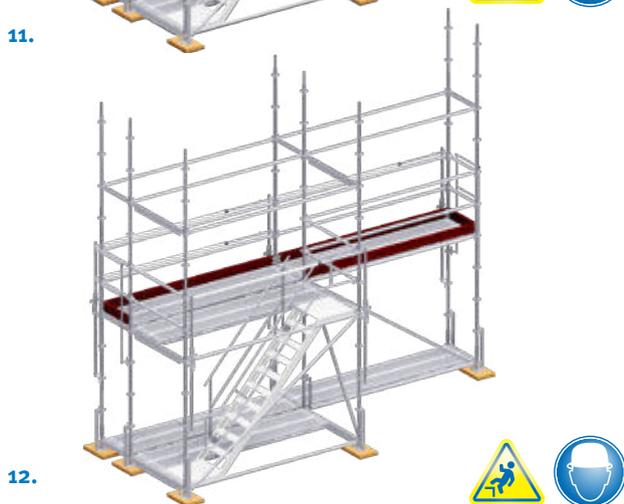
**12.** Danach wird das Bewehrungsgerüst aufgestockt in dem auf die Vertikalstiele 3,00 m aufgesteckt und sofort mittels Fallstecker gesichert werden. Anschließend erfolgt die Verbindung der aufgesteckten Vertikalstiele in Längs- und Querrichtung mit Rohrriegeln und U-Riegeln.
